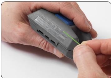
12. Kontrollér længden af den strippede fiber.
