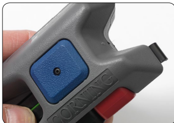
17. Overskydende fiber stikker ud i den anden ende af cleaveren.
