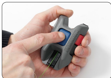
18. Knæk fiberen ved et tryk på den blå knap.
