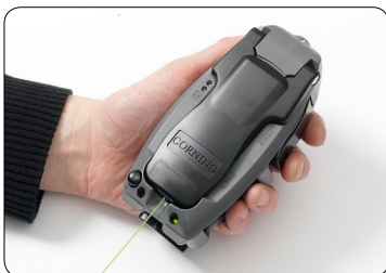
21. Når fiberen er ført helt ind i konnektoren, låses den ved at trykke på den nederste knap i højre side af værktøjet.
