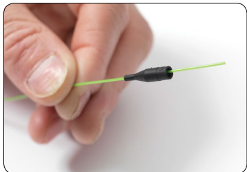
8. Sæt kabeltyllen på fiberen.
