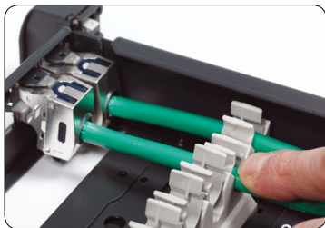
12. Kablerne trykkes i kabelorganisatoren og derved undgås strips.
